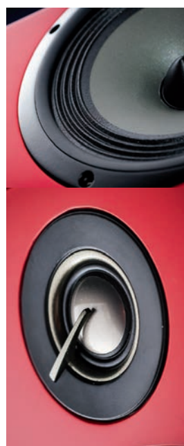
Charakterystyczne harmonijkowe zawieszenie średniaka i nietypowy rozpraszacz metalowej kopułki.
